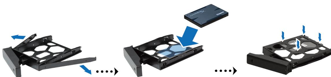
4 将装好硬盘的托盘放入空的硬盘插槽。
