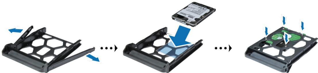
4 请确认侧边标示“UP”的一面朝上，然后将托盘置入空的硬盘插槽。当托盘锁定到位时，您会听到咔嗒声。
