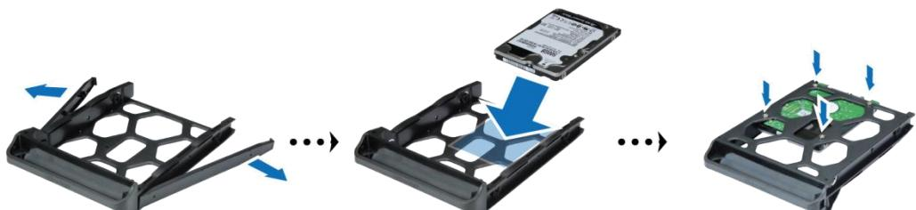
**4 请确认侧边标示“UP”的一面朝上，然后将硬盘托架插入空置的硬盘插槽。当托架锁定到位时，您会听到咔嗒声。**
