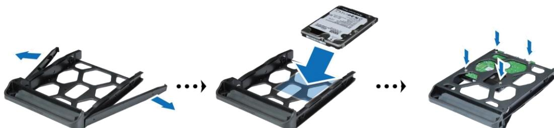
4 请确认标示“UP”的面朝上，并将硬盘托架插入空置的硬盘插槽。当托盘锁定到位时，您会听到咔嗒声。
