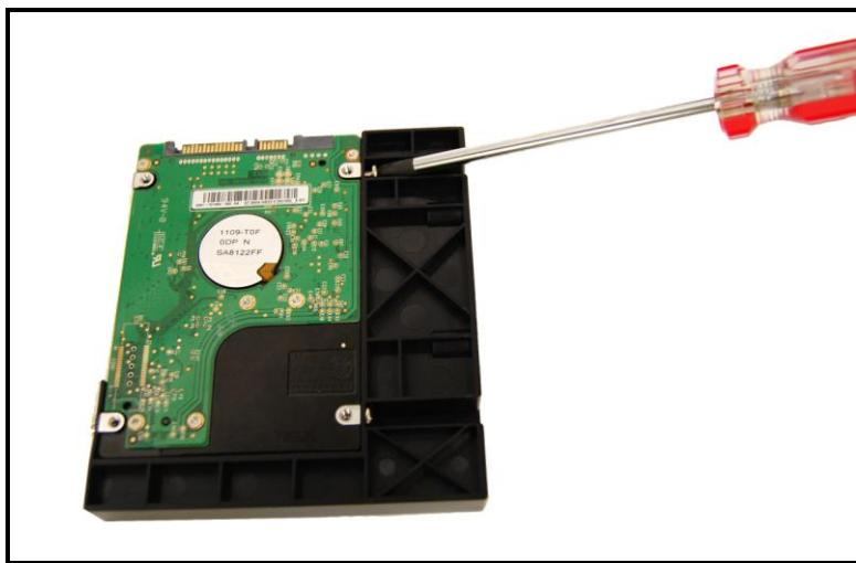
将2.5吋硬盘架滑入硬盘托架，并确实推紧使硬盘接上连接接头。使用两颗硬盘螺丝从侧边将硬盘架固定。
