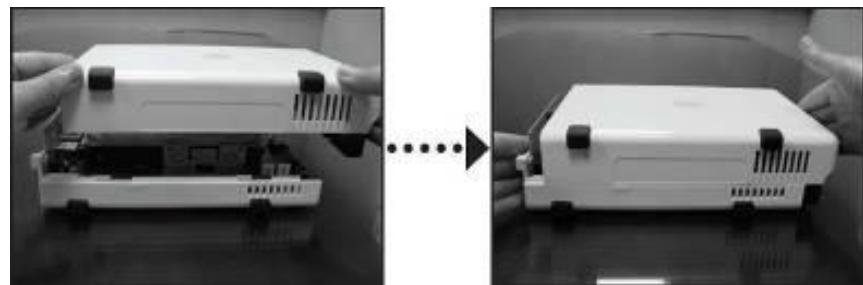
7. Befestigen Sie das Gehäuse mit den 2 mitgelieferten Schrauben.
