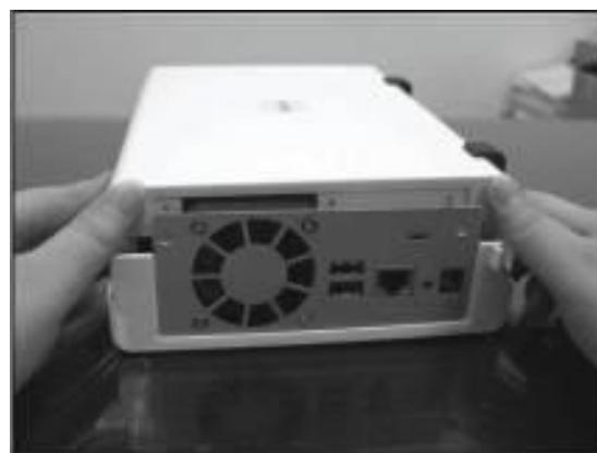
3. Heben Sie den oberen Gehäuseteil nach oben hin ab.
