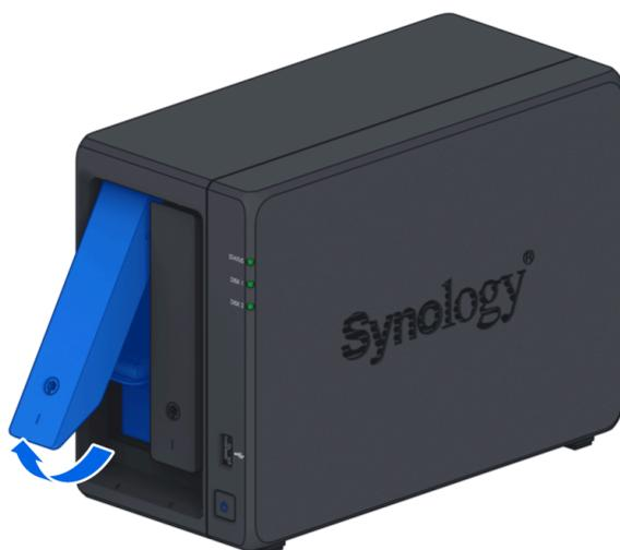
2. Retire los paneles de sujeción de los lados de la bandeja de la unidad. Coloque la unidad en la bandeja de la unidad. Luego inserte los paneles de sujeción para asegurar la unidad en su
