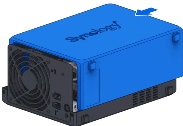
6. Vuelva a instalar los tornillos que aseguran el panel trasero.
