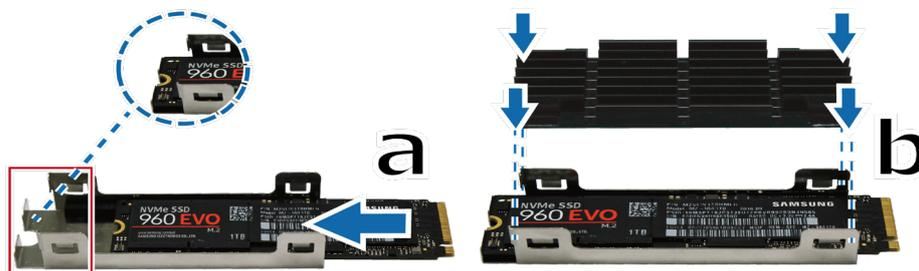
**Observación:** Extraiga el film extensible de la parte inferior del disipador térmico antes del paso 3-b.
