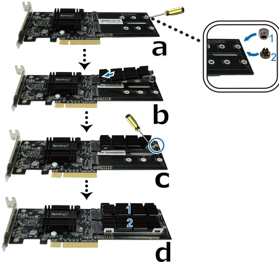
**5** Instale la tarjeta adaptadora M2D18:
