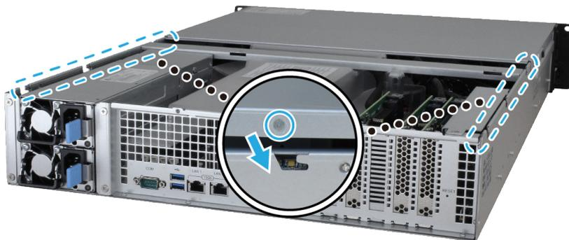
b Volte a colocar e aperte o parafuso que retirou no passo 2-a.
