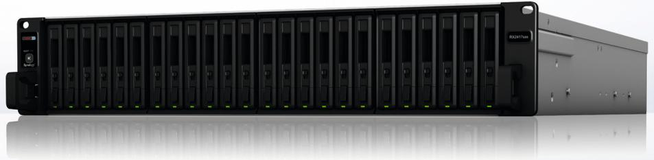
Synology RX2417sas ofrece una solución sin esfuerzo para la copia de seguridad de datos y la expansión de volumen para Synology FlashStation<sup>1</sup>/RackStation<sup>2</sup> al añadir 24 bahías de disco SATA/SAS sobre la marcha. Synology RX2417sas está cubierto por la garantía limitada de 5 años de Synology.
